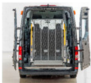
NEW VW Crafter Behindertenbus mit Linearlift, Aluboden und geprüften M1 Sitzen
